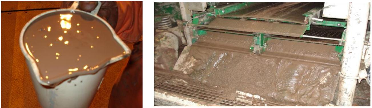
**Figur 1. Oljebasert boreslam og oljebasert kaks på shaker, (foto fra Statoil).**
