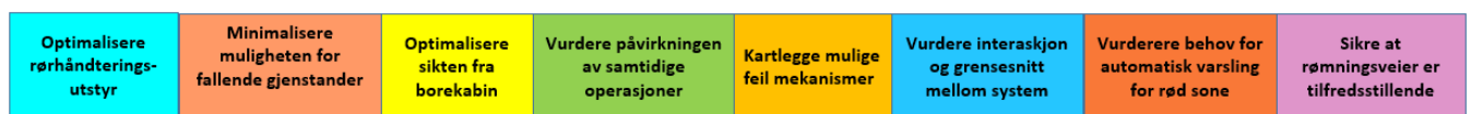
Figur 2.2 Elementer i prosessen for å håndtere arbeid på rød sone i design av et boredekk.
