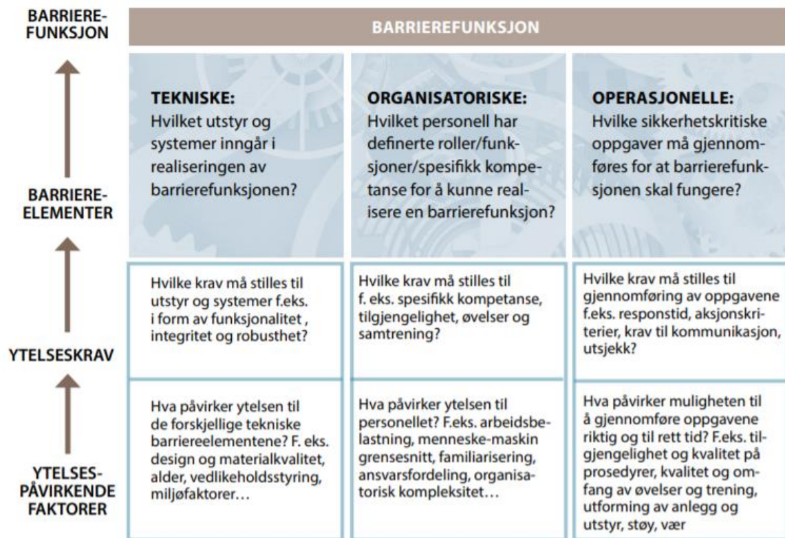
Figur 1-2 Forholdet mellom barrierefunksjon, barriereelementer, ytelseskrav og ytelsepåvirkende faktorer
