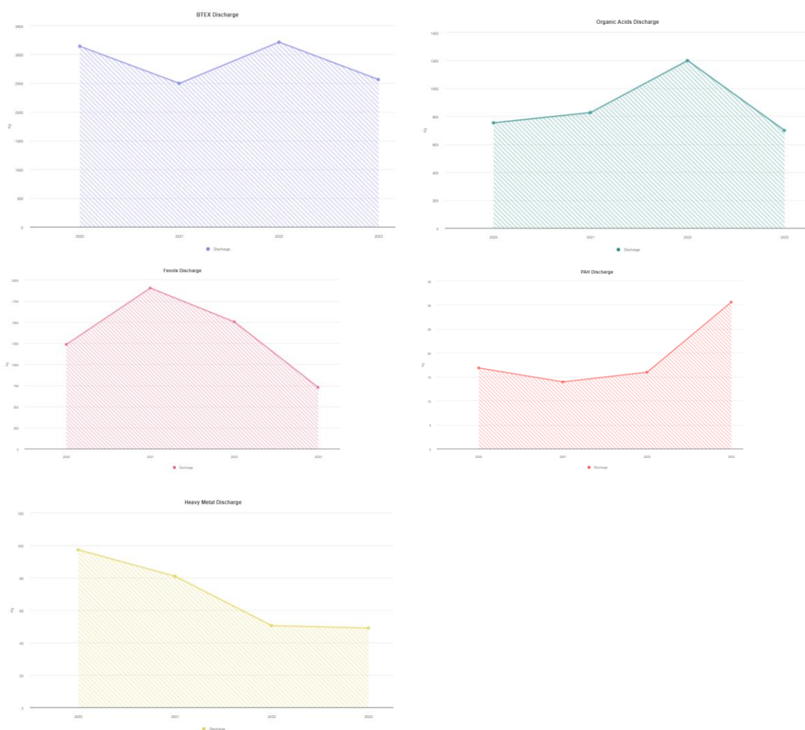
Figur 2: Variasjon i komponenter i produsert vann fra 2020 til 2023. Øverst fra venstre BETX, Organiske syrer, Fenoler, PAH og tungmetaller.
