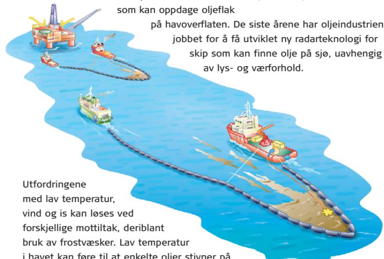
Utfordringene med lav temperatur, vind og is kan løses ved forskjellige tiltak, deriblant bruk av frostvæsker. Lav temperatur i havet kan føre til at enkelte oljer stivner på sjøen. Det er derfor utviklet oljeoppsamlere som er spesielt egnet til å håndtere slike oljetyper.
