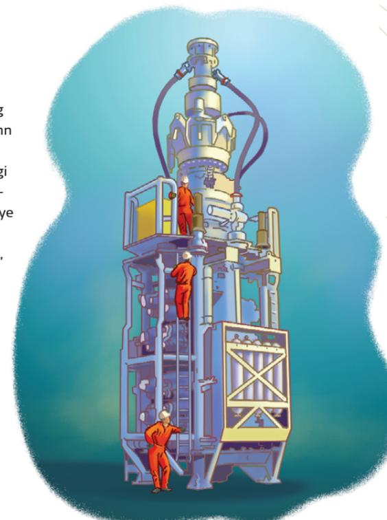
Utblåsningssikringen består av 3-5 store ventiler som kan stenges, slik at olje og gass ikke får strømme til overflaten.
