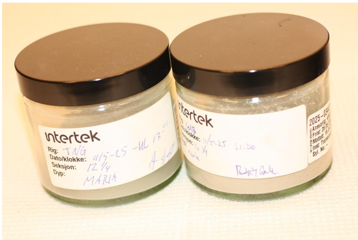
Figur 6 Prøver fra Maria. Mesteparten av tørrstoffet var i størrelsesorden 0-0,1 mm.
