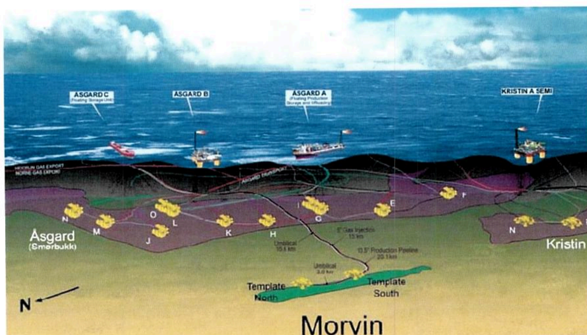
Figur 1.1: Utbyggingsløsning for Morvin med brønnstrøm til Åsgard B
