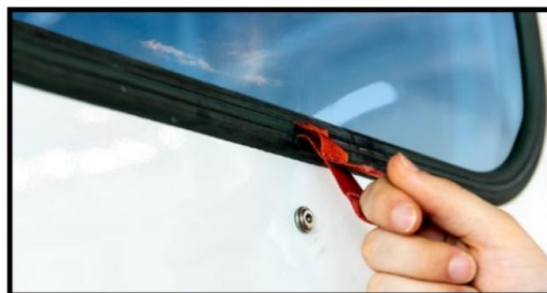
Åpning av nødutgang vinduer
