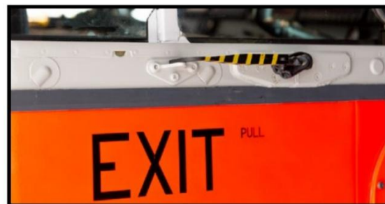
Åpning i nødutganger ved piloter
