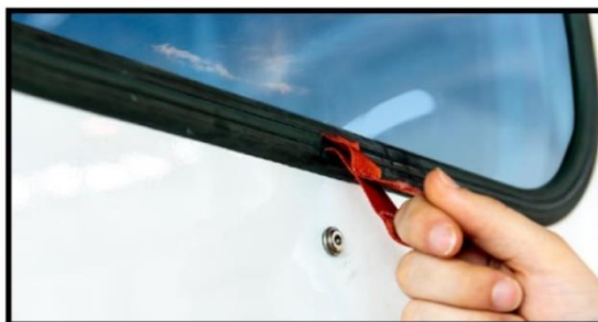
Åpning av nødutgang vinduer
