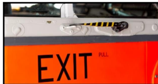
Åpning i nødutganger ved piloter
