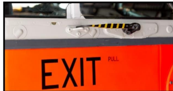
Åpning i nødutganger ved piloter
