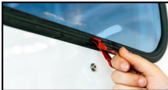
Åpning av nødutgang vinduer
