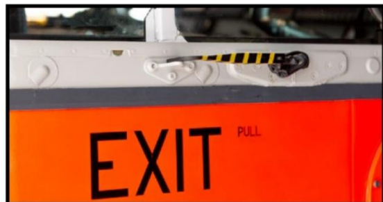
Åpning i nødutganger ved piloter
