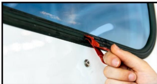
Åpning av nødutgang vinduer
