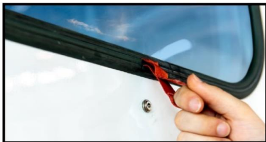
Åpning av nødutgang vinduer
