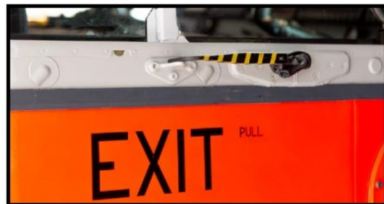
Åpning i nødutganger ved piloter
