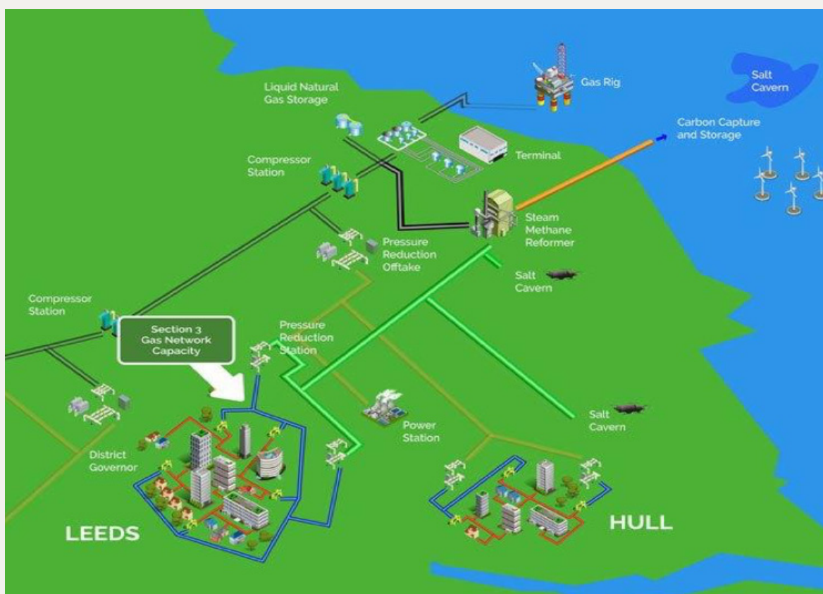
Konsept for fullskala verdikjede for hydrogen fra naturgass med CO 2 fangst og lagring
