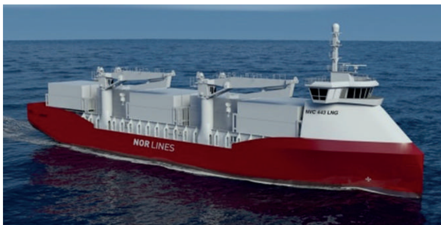
Godsskip med LNG-motor og plug-in hybrid framdrift (Foto: Rolls Royce)
