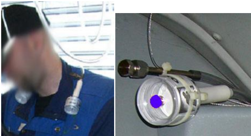
Figur 1: Venstre: Plassering av personlige prøvetakere. Høyre: Plassering av ATD-rør ved siden av oljetåkeprøvetakeren (her er det vist ved en stasjonær montering).
