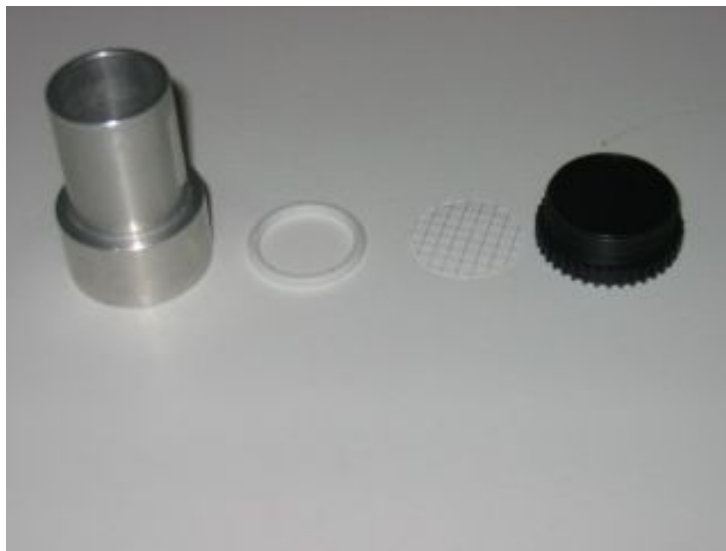
Figur 8.11 – Metallhette og prøvetaker for fiberprøver
