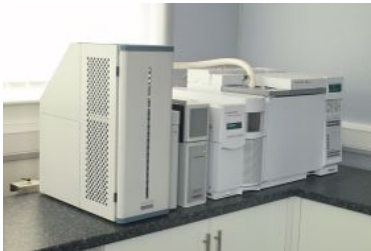
Figur 9.8– Termisk desorpsjonsenhet med GC/MS
