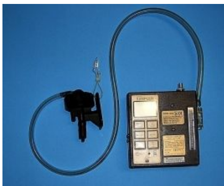
Figur 8.15 – Prøvetakingsoppsett for respirabelt støv
