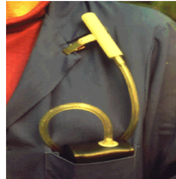
Figur 9.3 – Personlig prøvetaking med oppsamling vha. sorbentrør
