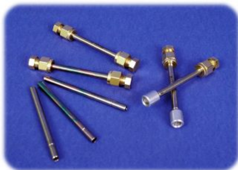
Figur 9.7 – Vanlige termiske desorpsjonsrør
