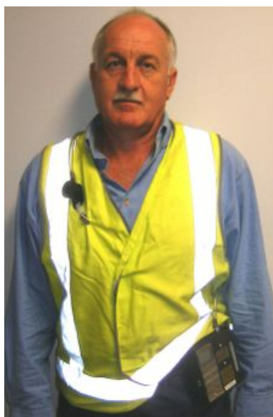
Figur 8.16 – Prøvetakingsoppsett festet på en arbeider
