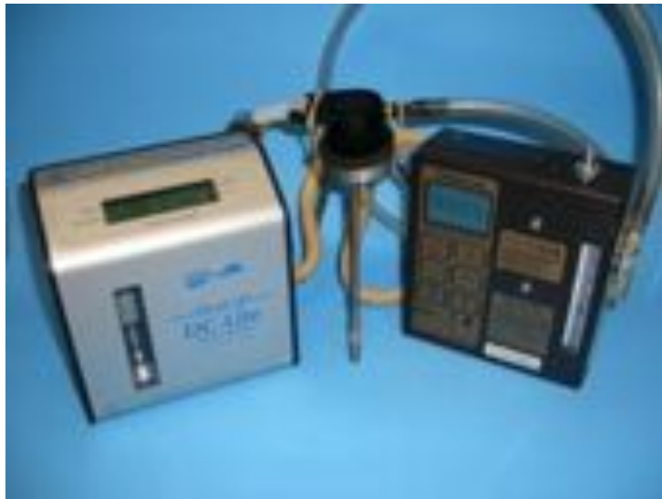
Figur 8.21 – Kalibrering ved hjælp af en elektronisk måler
