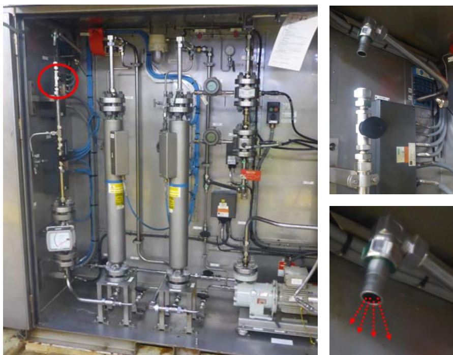
Figur: Rød ring indikerer hvor det var svettelekkasje i fittings ved siste utløpsventil fra analysekabinettet, 25 mm tubing løsnet da vedlikeholdsoperatør prøvde å trekke til fittings, olje og gass strømmet ut
