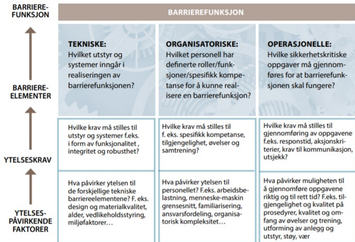
Figur 1-2 Forholdet mellom barriererefunksjon, barriereelementer, ytelseskrav og ytelsepåvirkende faktorer
