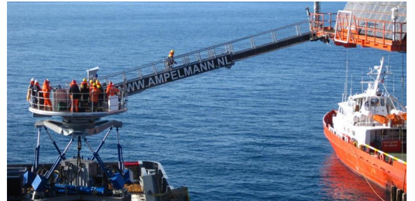
Stabilisert gangveg med hivkompensasjon
