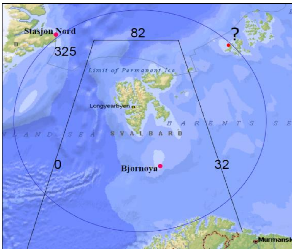
Figur 4-4 Operasjonell distanse for helikopter som opererer fra Longyearbyen. De røde prikkene viser mulige lokasjoner for refueling (ref.14)
