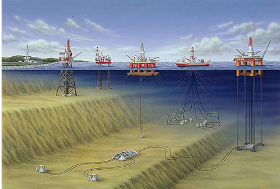
Figur 1 Ulike konsepter med varierende havdyp. Fra venstre Jacket, jack-up, Semi, FPSO-skip, TLP
