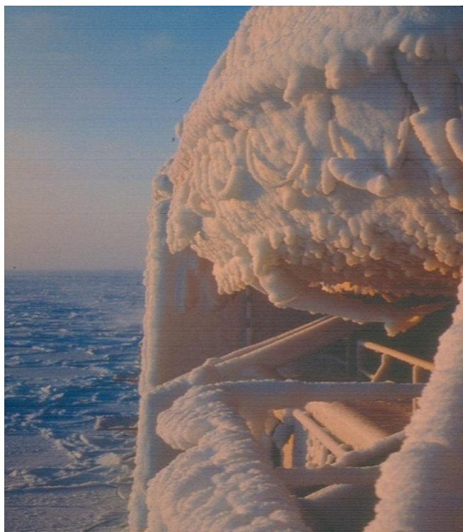
Figur 5 Bildet viser livbåtstasjon på et fartøy i arktisk klima, eksponert for isingsforhold (Fotografi: S. Løset, 2006).
