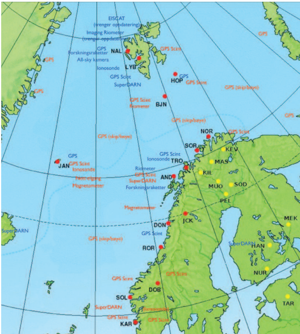
Figur 15: Infrastruktur i Norge og i Nordområdene. Blå skrift er eksisterende utstyr, mens rød skrift er ønsket infrastruktur. De røde prikkene er magnetometerkjeden til TGO, mens de gule prikkene er ikke-TGO-eide magnetometre. Figuren er modifisert fra figur 16.
