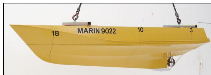
Figur 5 Modell med skala 1:5, Livbåt A, brukt ved testing hos Marin (© Marin)
