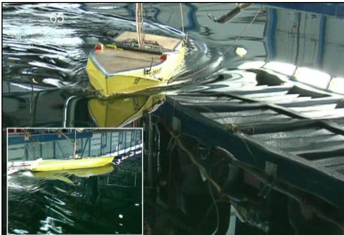
Figur 9 Livbåtmodell avbildet under sikksakk manøvertest hos Marin (© Marin)
