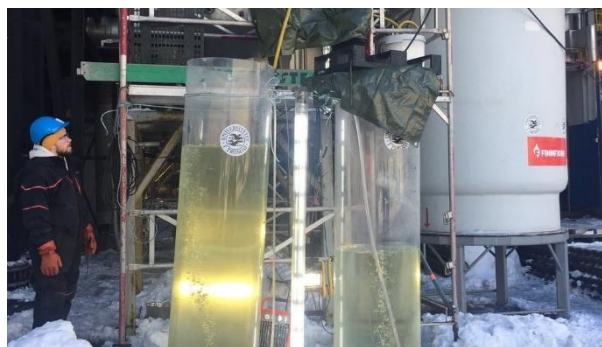
Figur 25. Dyrking av kiselalger i vann med røyk fra smelleanlegget i Finnfjord, Troms. Hentet fra [96].
